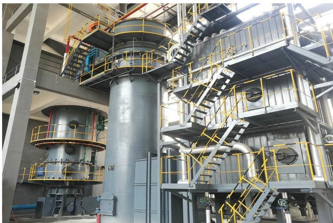
图2.4-3 热解气化炉
